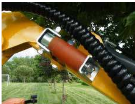
ANTIURTO DI SICUREZZA RELEASE SAFETY DEVICE
