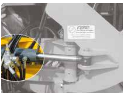
SICUREZZA IDRAULICA ANTIURTO SHOCK RESISTANT HYDRAULIC SAFETY DEVICE
